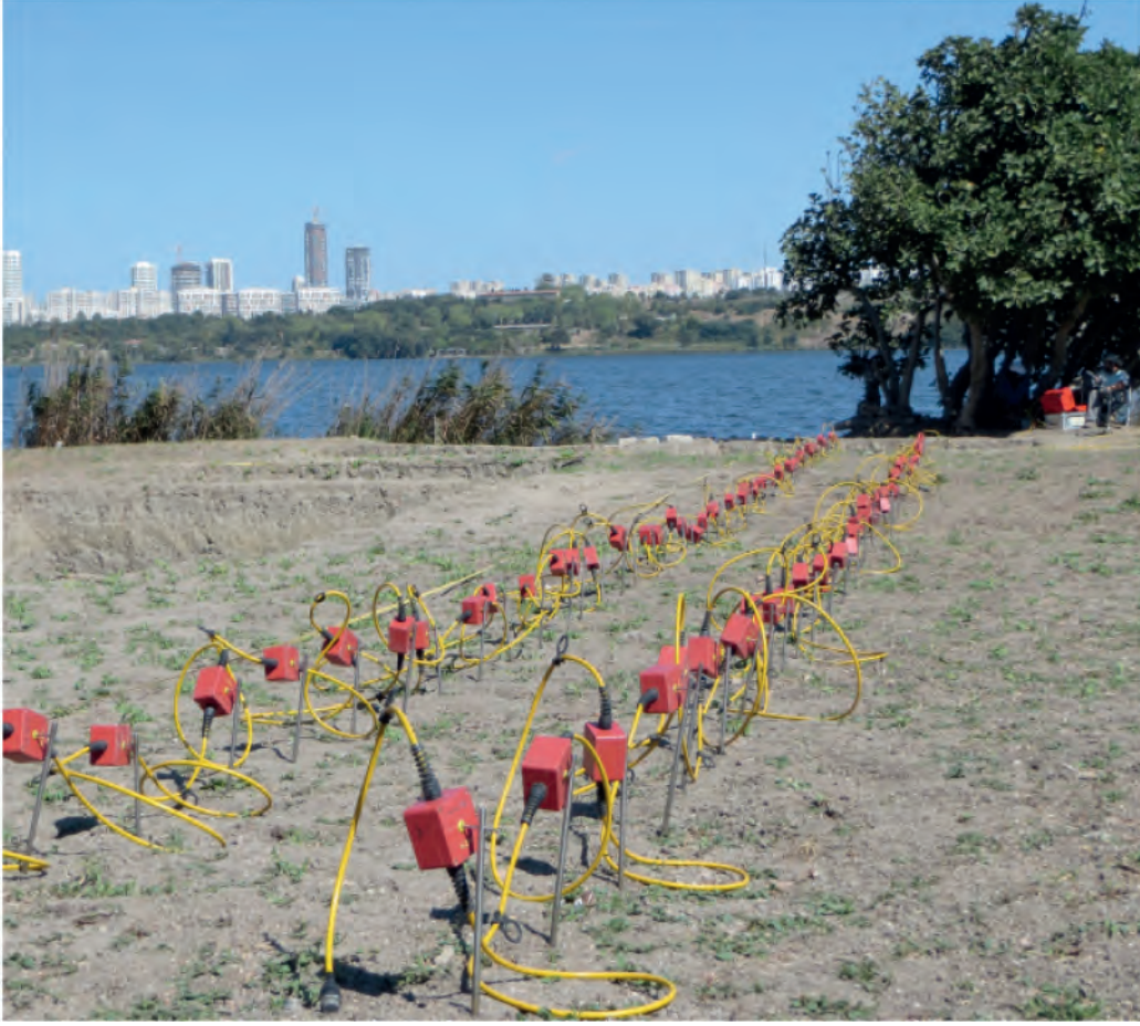
Res. 3: RESECS-Multi-Elektrot-Sistemi ile çok elektrotlü jeoelektrik profil ölçümü.
